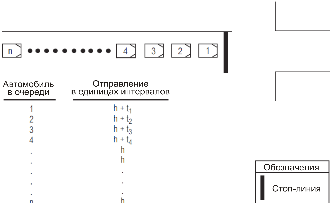
Рис. 7-3. Условия прерывания трафика на полосе подъезда к регулируемому перекрестку
